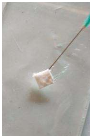
Figura 59: Humectando la compresa con agua destilada
