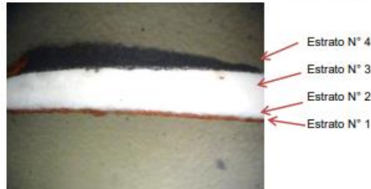
Figura 6: Micrografía de corte estratigráfico de esgrafiado sobre pan de oro (Glicerina)
