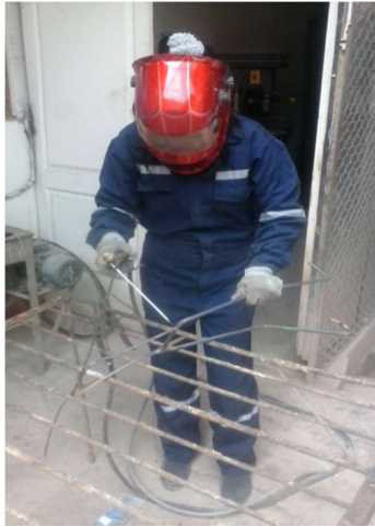
Figura 13: soldando la estructura metálica que será el soporte de la escultura.
