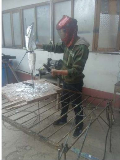
Figura 1: Soldando la estructura metálica y aplicando las piezas de tecnopor para el volumen.
