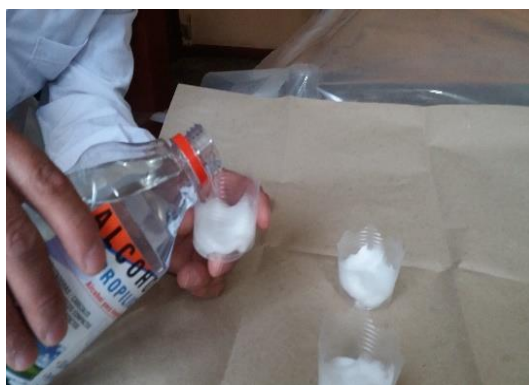
Figura 52: Humectación del algodón con el alcohol isopropílico.
