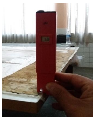
Figura 46: Potenciómetro en contacto con la superficie del soporte.
