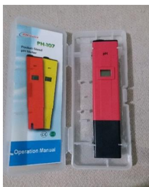
Figura 45: Potenciómetro Digital H tester – 107.
