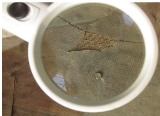
Figura 49: Se aprecia la no absorción de la gota de agua.
