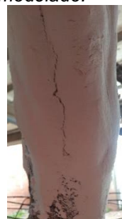
Figura C84 Rajadura del modelado.
