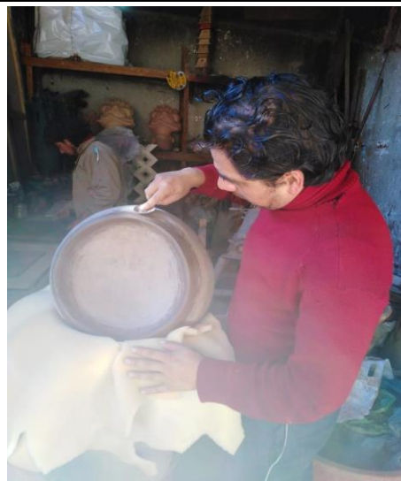
Figura N° 65: Reforzamiento de la parte externa del laminado. Fuente: Elaboración propia.
