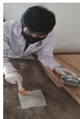
Figura 36 y 37. Aplicación de coleta italiana con brochas.
