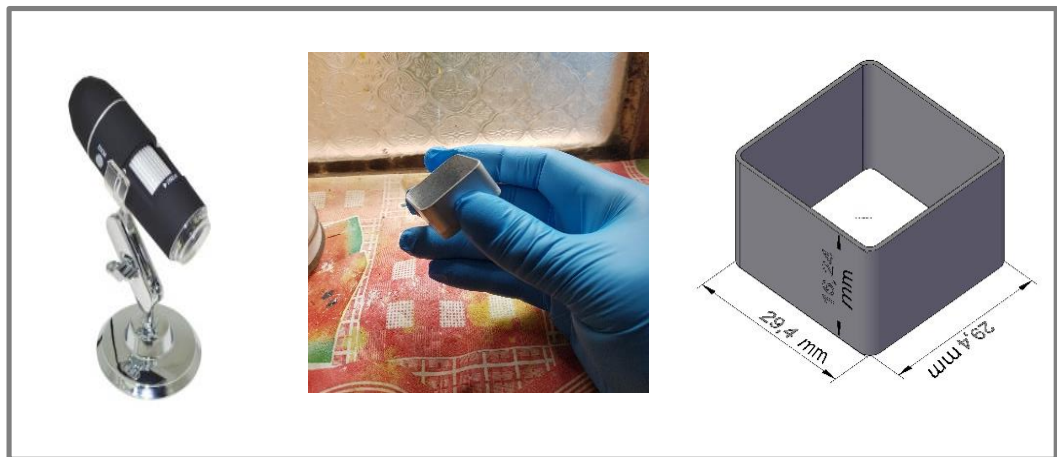
Figura 9: microscopio USB, molde y dimensi3n Nota: Registro propio
