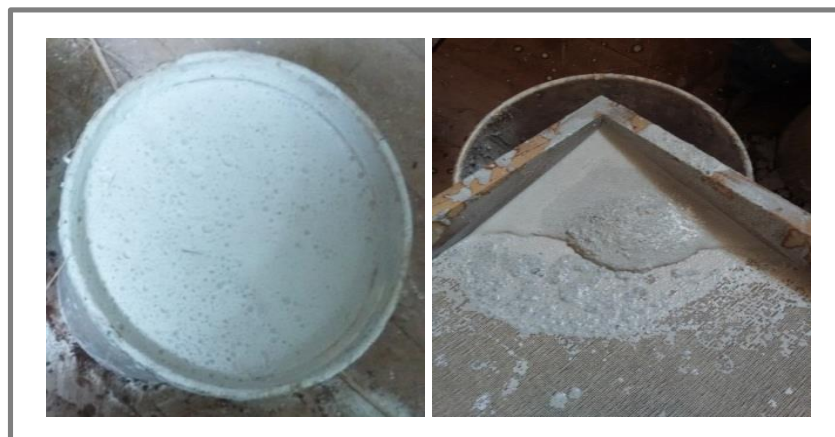
Figura 5: Hidratación de la cal Figura 6: Tamizaje de la cal hidratada
