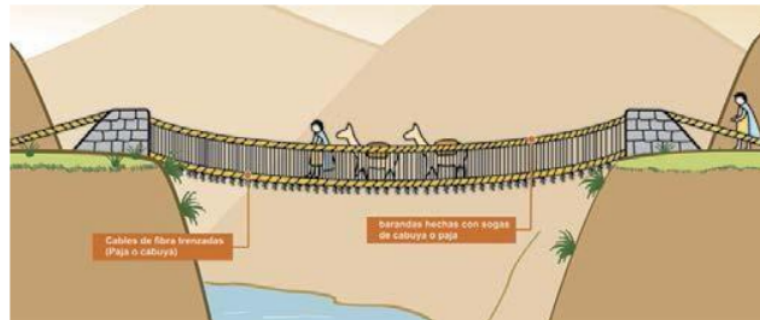
Figura 30. Puente colgante incaico. Dibujo elaborado por G. Bedoya (2014)
