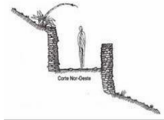
Figura 20. Calzadas encerradas por muros. (Dibujado por J. Arana).
